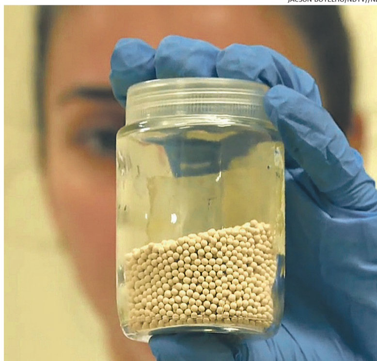
Bolinhas chamadas de zeolitas foram produzidas em laboratório e fazem a captura de dióxido de carbono
