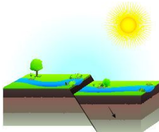
Esquema de uma falha geológica que pode dar origem a um terremoto
